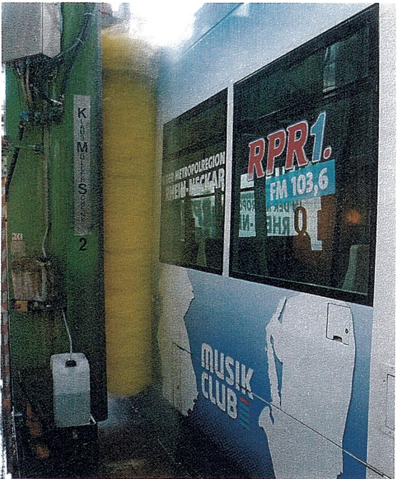
Reinigung am Standort Mannheim-Möhlstraße – Einsatz des oberflächenschonenden Reinigers LoClean Alk mit gleichmäßigem Sprühbild und optimal konturierten Bürsten
