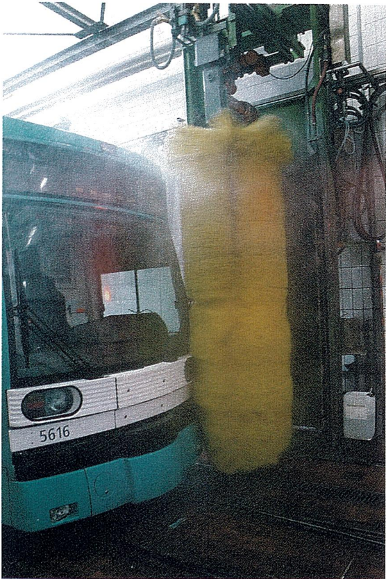
Frontreinigung am Standort Mannheim-Möhlstraße
