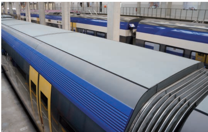
BILD 1: Sauber durch Selbstreinigung: Dächer der NOB-Reisezugwagen
